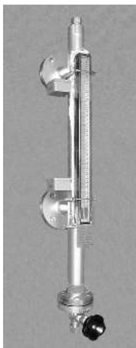
Typ 710.104.0 s limitními spínacími MIN - MAX, odvzduš ní - zátkou odkalení - ventil zobrazovací lišta - AVG3 s izolací
